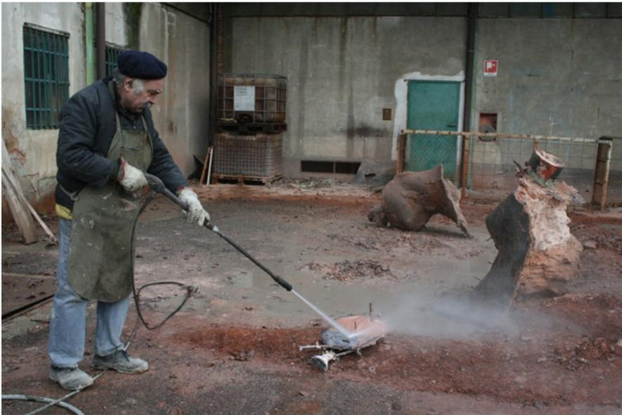
55.-56. pulitura della fusione con idrogetto
