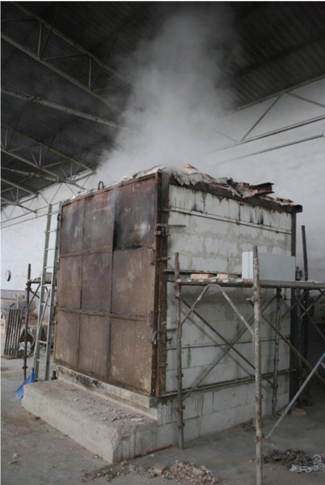
46. fornace in funzione per la cottura delle forme e la "perdita della cera"
