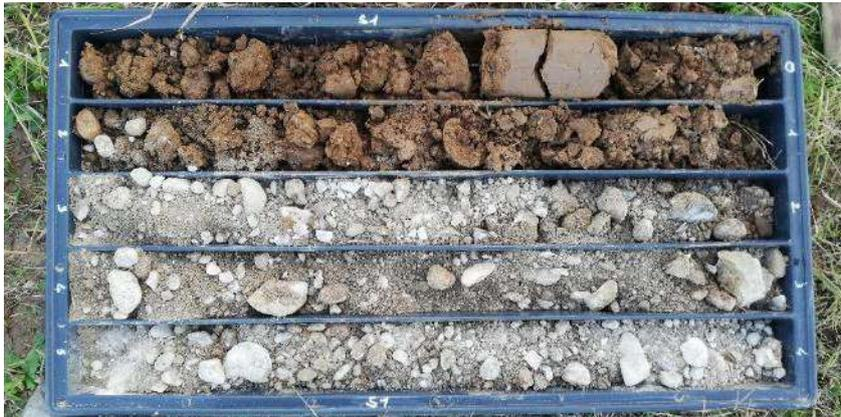
*Foto 2: sondaggio S1 da 0 m a 5 m*
