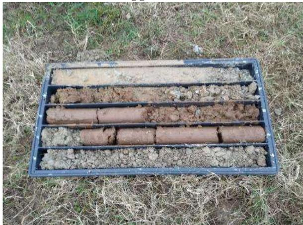
*Foto 7: sondaggio S2 da 5 m a 10 m*
