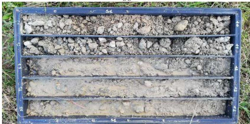
*Foto 4: sondaggio S1 da 10 m a 15 m*
