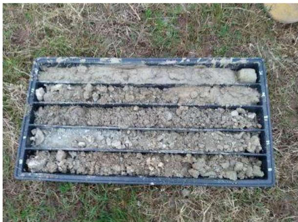
*Foto 8: sondaggio S2 da 10 m a 15 m*
