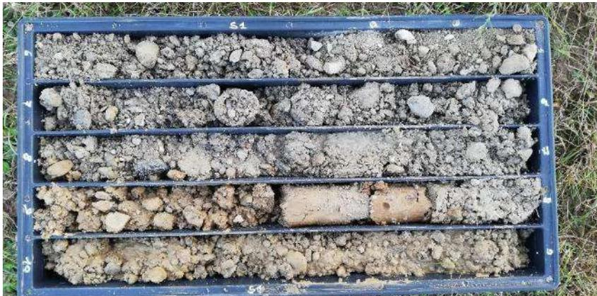
*Foto 3: sondaggio S1 da 5 m a 10 m*
