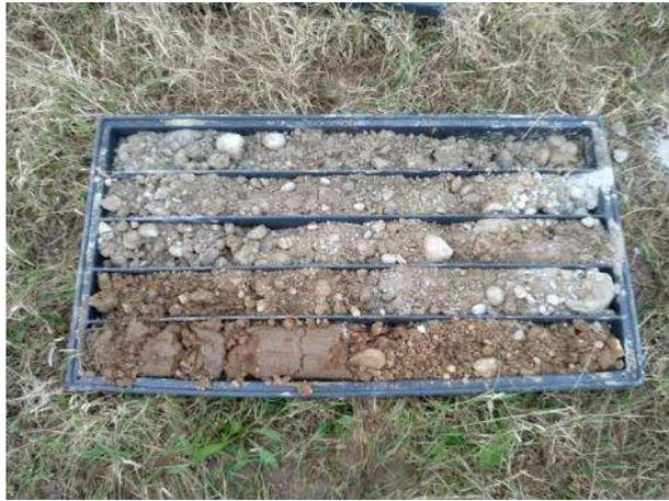
*Foto 6: sondaggio S2 da 0 m a 5 m*
