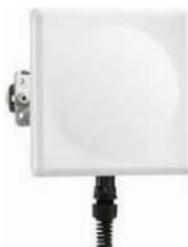
Tipo **Outdoor Bridge S DUAL**: adatto per applicazioni Punto-Punto di breve distanza fino a 6km ad alto trasporto di banda. La banda effettiva (throughput) può arrivare a 240Mbps (traffico UDP) in condizioni ottimali. Questo Bridge è un apparato da esterno, con interfaccia Ethernet Gigabit (10/100/1000 Mbps), antenna direttiva integrata da 18dBi MiMo (300Mbps) operante sulla banda di frequenza
