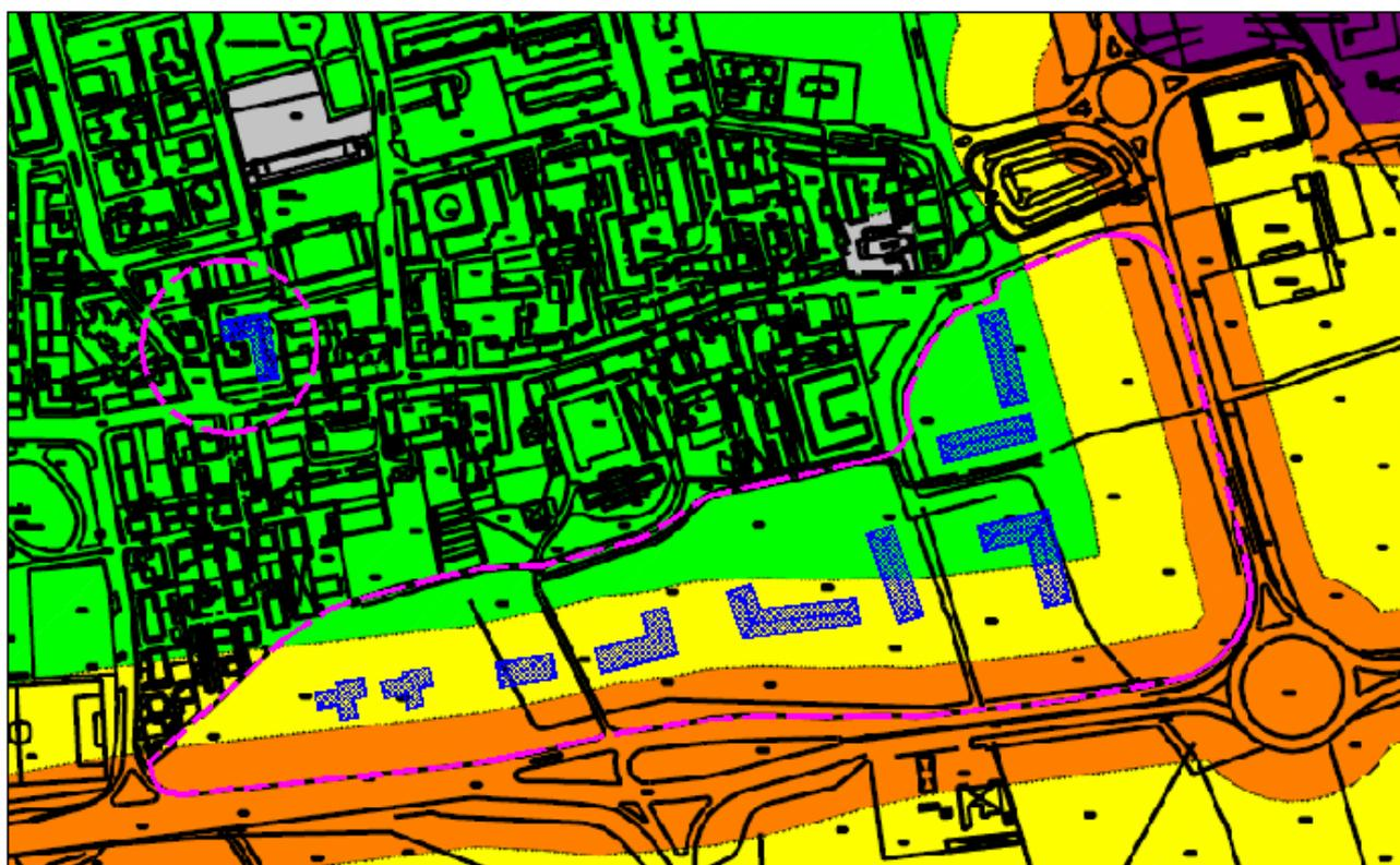
Figura n. 5 – Inserimento dei nuovi edifici nel piano di azionamento acustico
